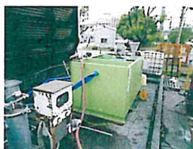
連続濁水処理装置 5m 3 /h
