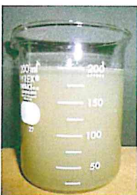
処理前（セメント洗浄水）
